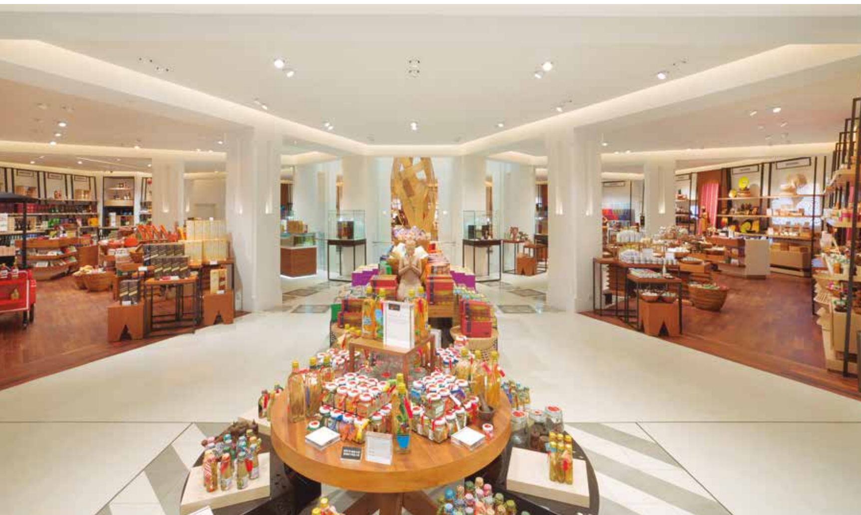
Sancas perimetrais iluminadas ajudam a estruturar e delimitar os ambientes, fornecendo iluminação indireta difusa e homogênea com perfis de LED 2.700 K, 19,2 W/m e IRC90. Nichos entalhados nos pilares recebem miniprojetores orientáveis de LED 2.700 K, 10°, 2 W e IRC90. Downlights orientáveis de LED 3.000, K 29 W, 12° ou 24° e IRC90 embutidos no forro complementam a iluminação de destaque dos espaços, permitindo flexibilidade para eventuais mudanças de layout.
