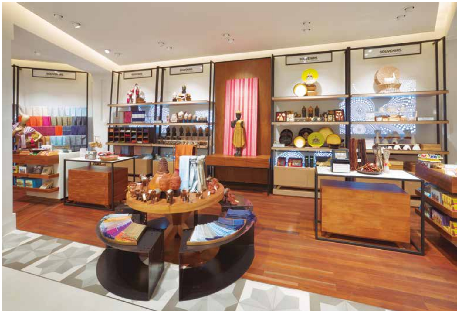
Telas retroiluminadas na parte posterior das estantes servem de fundo para os souvenirs com motivos locais. Foram desenvolvidas pela equipe de visual merchandising da DFS com o suporte dos lighting designers e dos arquitetos do projeto. Os projetores LED 3.000 K, 12° ou 24°, 29 W e IRC>90 embutidos no forro são orientados para destaque dos diversos produtos, ora nos expositores verticalizados e próximos das paredes, ora nos expositores espalhados pelo mall.
